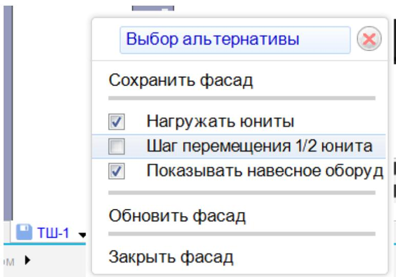
После включения опции оборудование будет перемещаться по  $\frac{1}{2}$  юнита.
